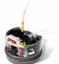
Misura di temperature su pistone con antenne rotorica e statorica - Manner®
