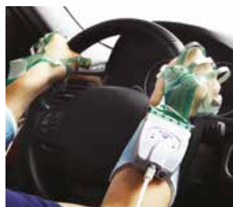
Grip™ - Viene applicato ad una mano o un guanto per misurare le pressioni statiche e dinamiche su oggetti impugnati
